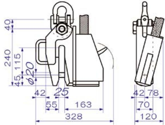
※クランプをセットする吊りピース等の寸法は、穴径はピン径+2mm以上、板厚は開口部の-1mm以下でお考えください。ご不明な点がございましたら何なりとお問い合わせください。
