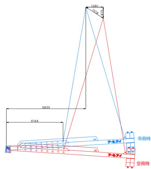
BBバランサー26000 2.0t吊り概算変動図
