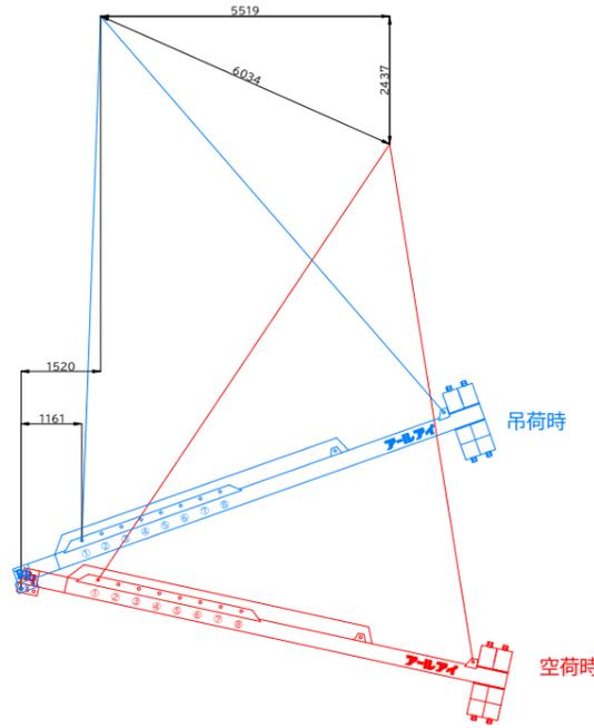
BBバランサー26000 22t吊り概算変動図
