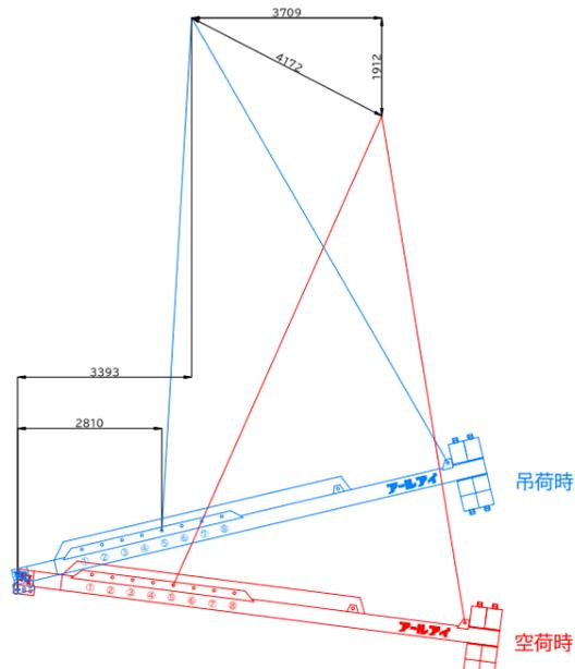
BBバランサー26000 7.5t吊り概算変動図
