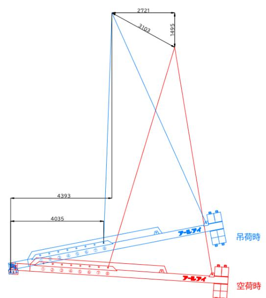
BBバランサー26000 4.5t吊り概算変動図
