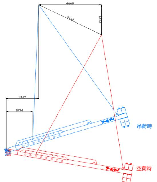
BBバランサー26000 12.5t吊り概算変動図
