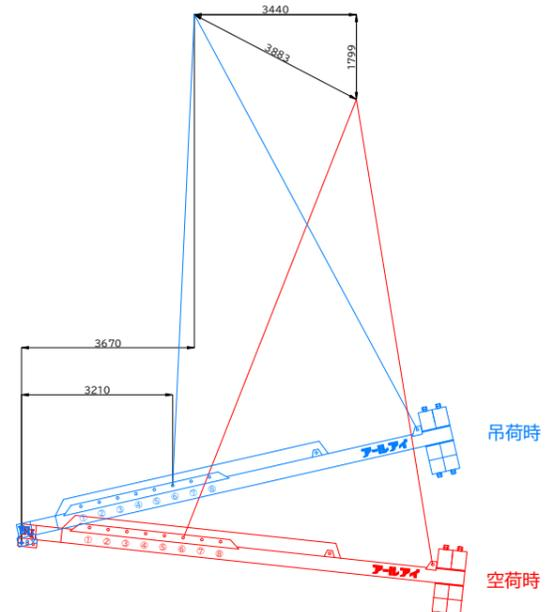
BBバランサー26000 6.5t吊り概算変動図
