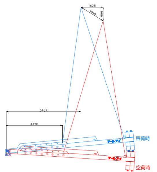
BBバランサー26000 2.5t吊り概算変動図
