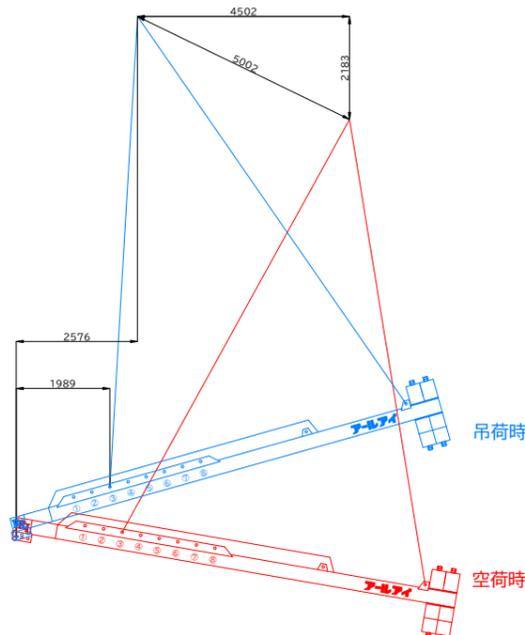
BBバランサー26000 11.5t吊り概算変動図
