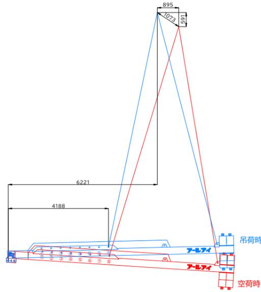
BBバランサー26000 1.5t吊り概算変動図
