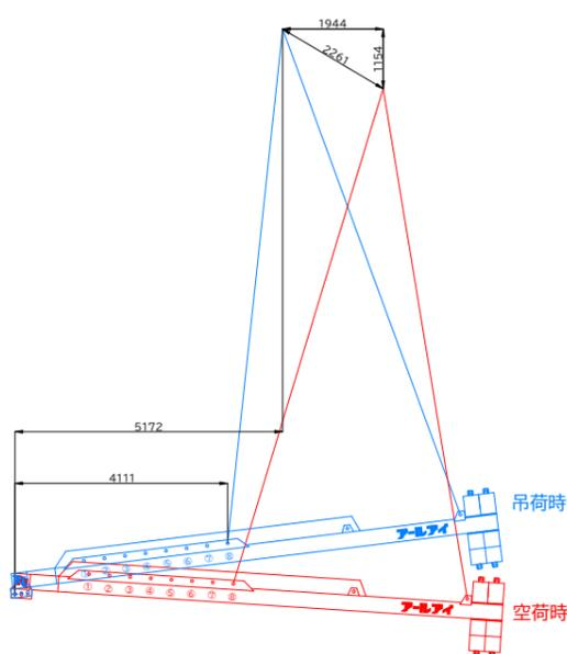
BBバランサー26000 3.0t吊り概算変動図
