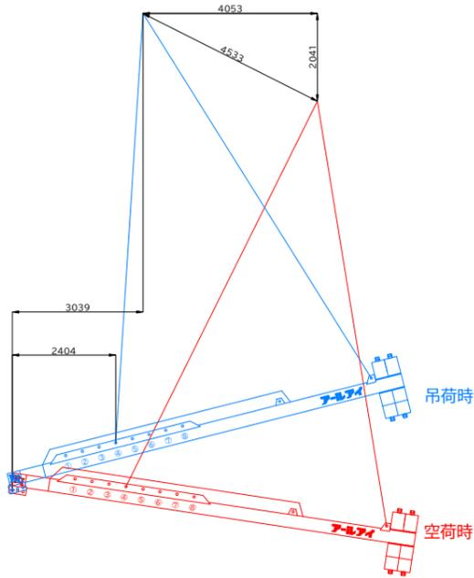
BBバランサー26000 9t吊り概算変動図
