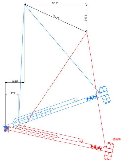
BBバランサー26000 20.5t吊り概算変動図
