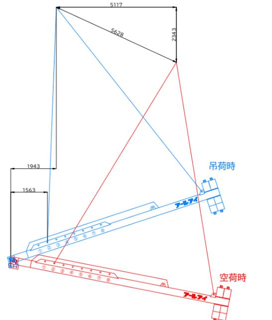
BBバランサー26000 16.5t吊り概算変動図
