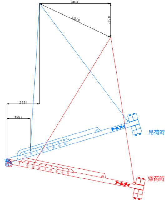
BBバランサー26000 14t吊り概算変動図
