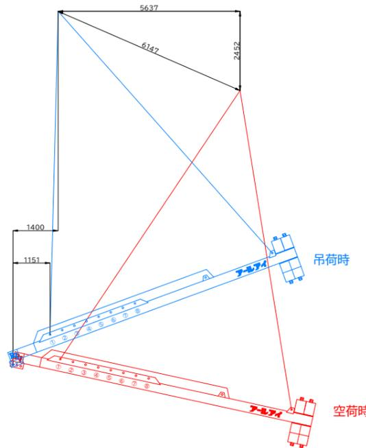
BBバランサー26000 24t吊り概算変動図
