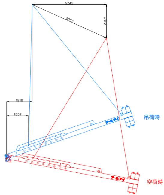
BBバランサー26000 18t吊り概算変動図
