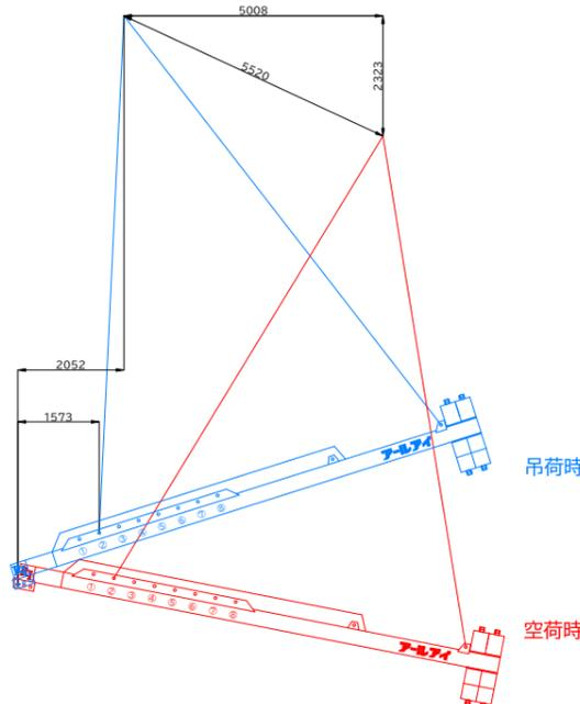
BBバランサー26000 15.5t吊り概算変動図
