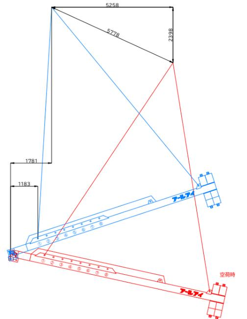
BBバランサー26000 18.5t吊り概算変動図
