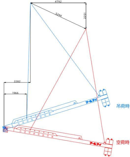
BBバランサー26000 13.5t吊り概算変動図
