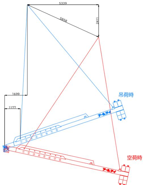
BBバランサー26000 19.5t吊り概算変動図
