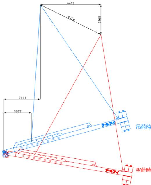
BBバランサー26000 11t吊り概算変動図
