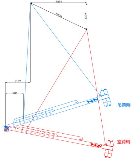
BBバランサー26000 14.5t吊り概算変動図
