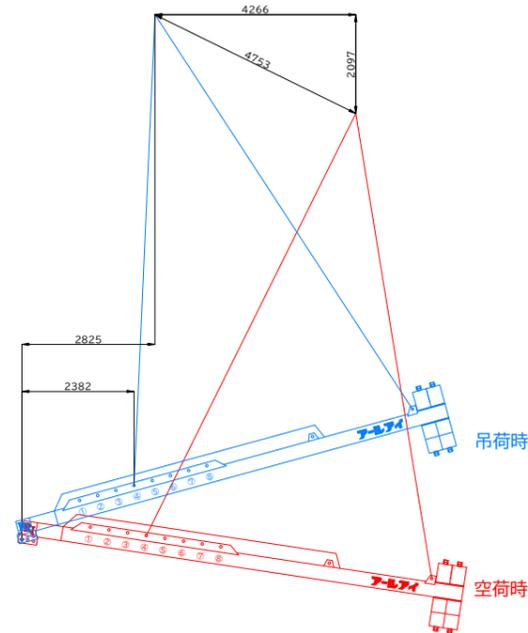
BBバランサー26000 10t吊り概算変動図
