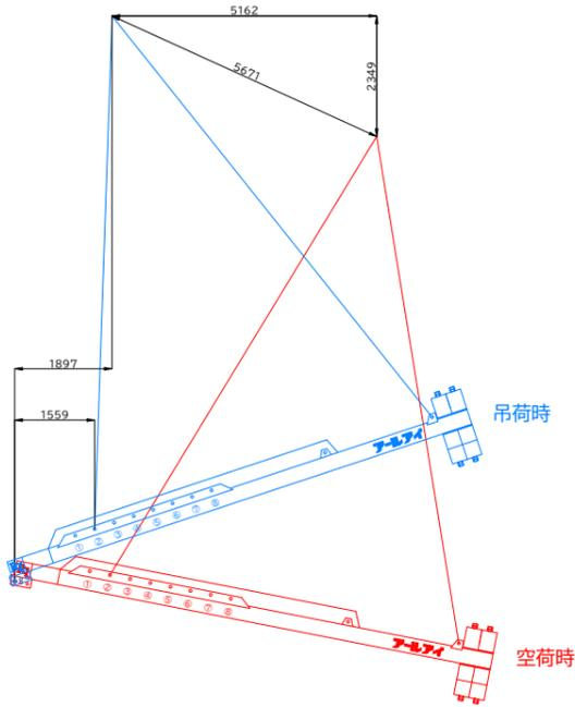
BBバランサー26000 17t吊り概算変動図
