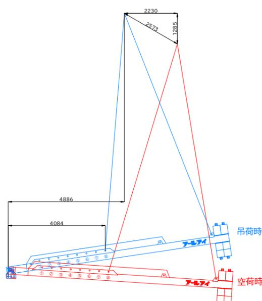
BBバランサー26000 3.5t吊り概算変動図
