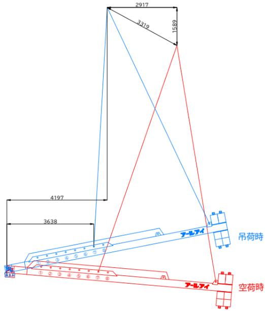
BBバランサー26000 5.0t吊り概算変動図
