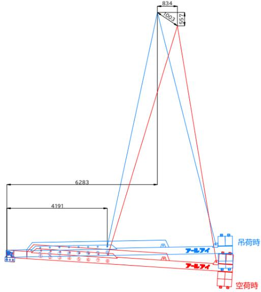
BBバランサー26000 1t吊り概算変動図
