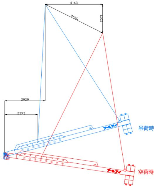
BBバランサー26000 9.5t吊り概算変動図
