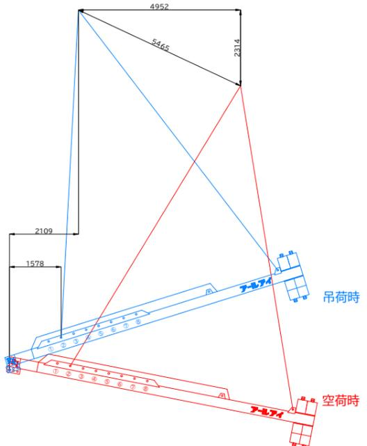
BBバランサー26000 15t吊り概算変動図
