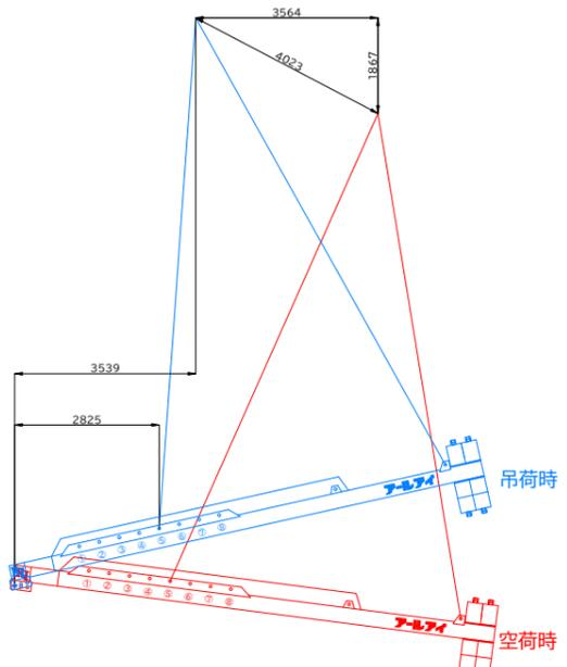
BBバランサー26000 7t吊り概算変動図
