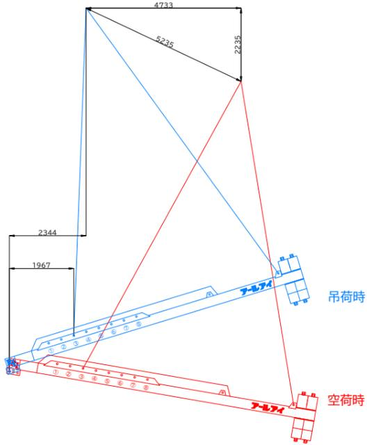
BBバランサー26000 13t吊り概算変動図
