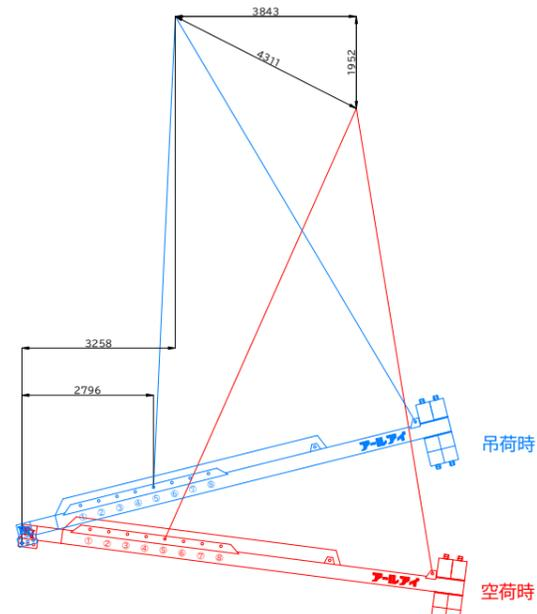
BBバランサー26000 8t吊り概算変動図
