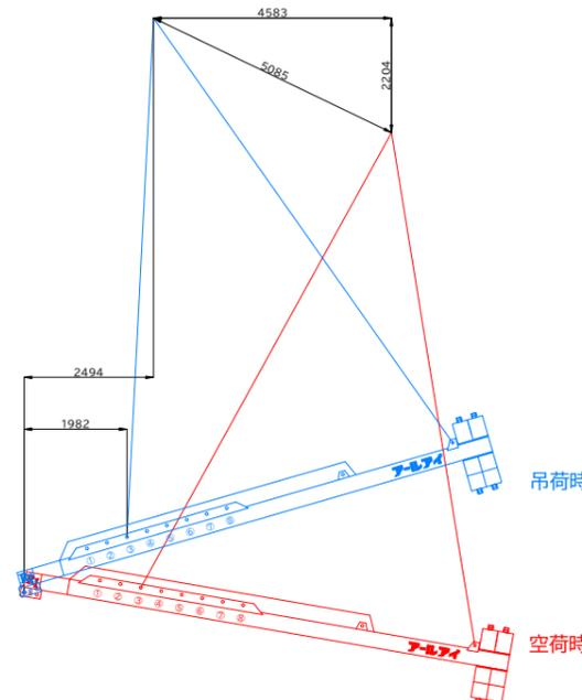
BBバランサー26000 12t吊り概算変動図
