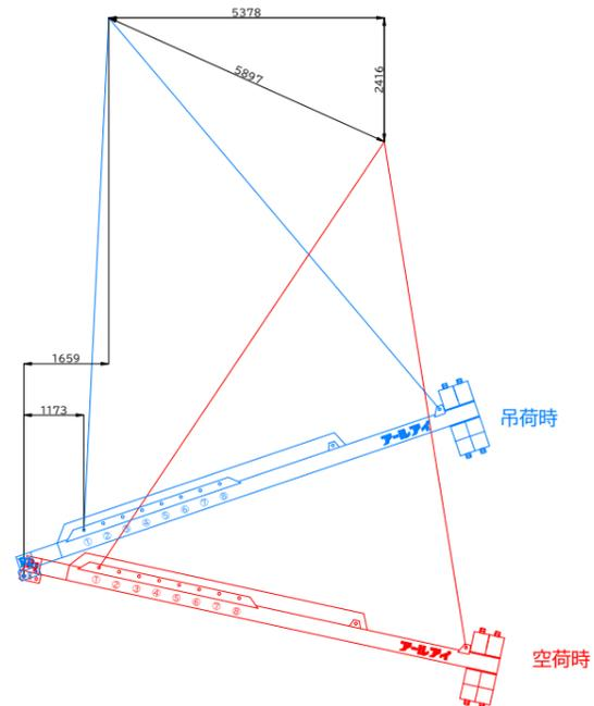
BBバランサー26000 20t吊り概算変動図
