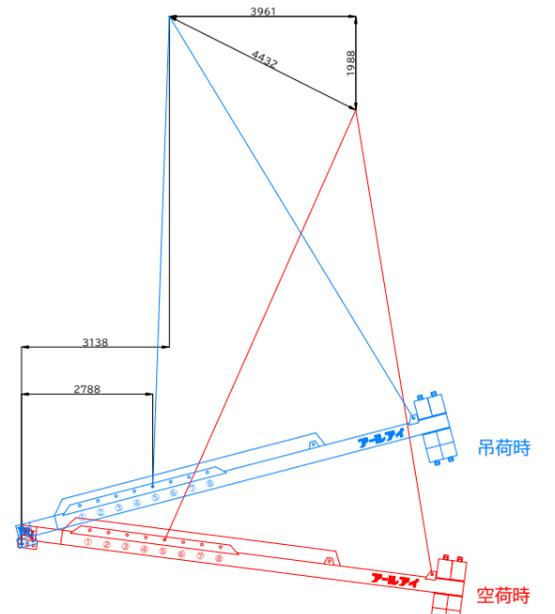
BBバランサー26000 8.5t吊り概算変動図
