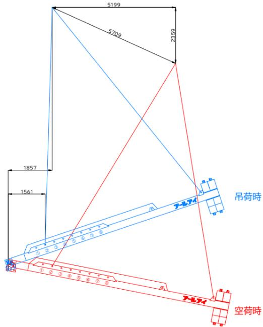
BBバランサー26000 17.5t吊り概算変動図
