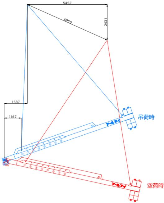
BBバランサー26000 21t吊り概算変動図
