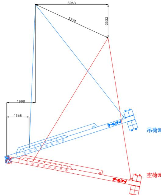
BBバランサー26000 16t吊り概算変動図
