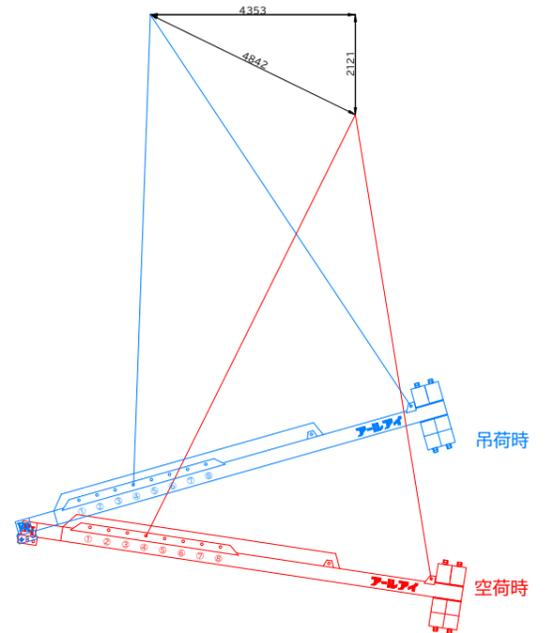
BBバランサー26000 10.5t吊り概算変動図
