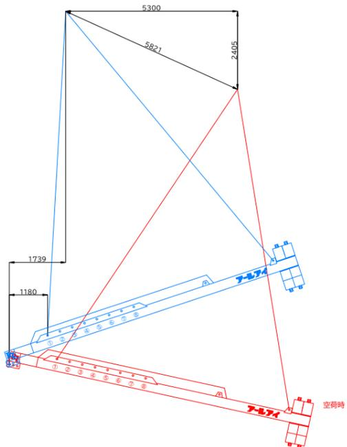
BBバランサー26000 19t吊り概算変動図
