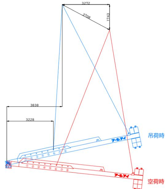
BBバランサー26000 6t吊り概算変動図
