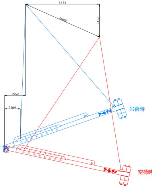
BBバランサー26000 21.5t吊り概算変動図
