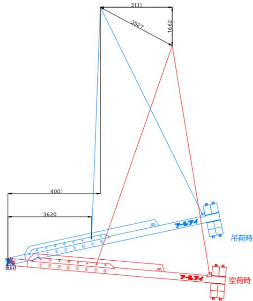
BBバランサー26000 5.5t吊り概算変動図
