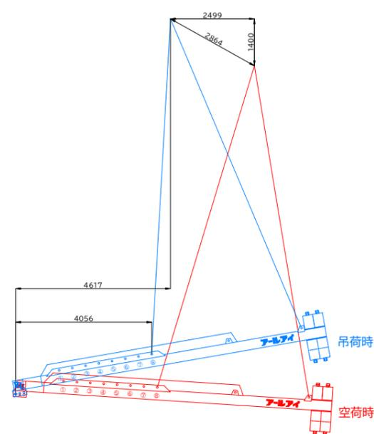
BBバランサー26000 4t吊り概算変動図
