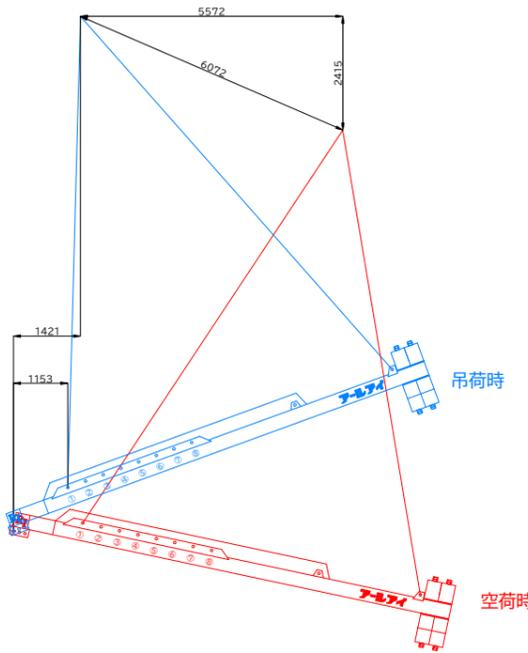
BBバランサー26000 23t吊り概算変動図
