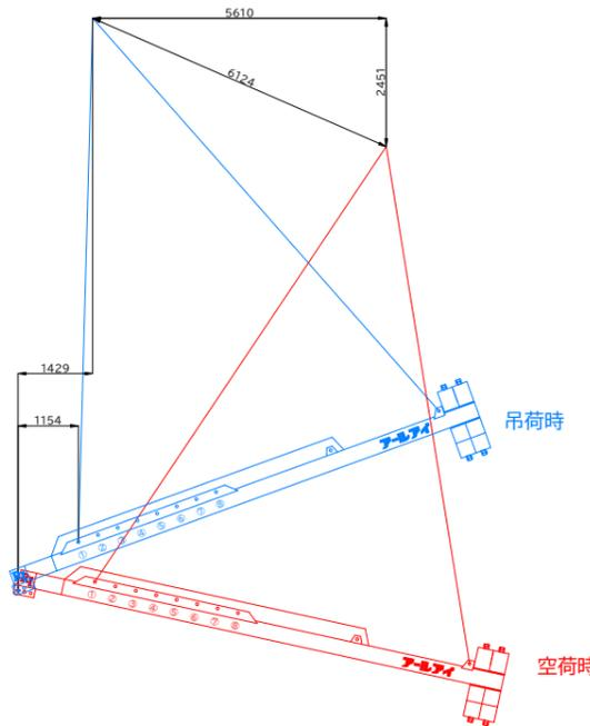
BBバランサー26000 23.5t吊り概算変動図
