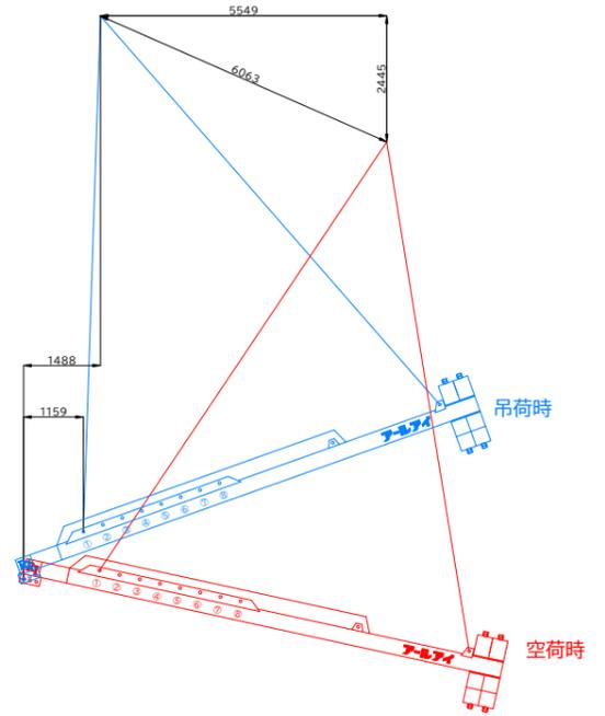
BBバランサー26000 22.5t吊り概算変動図
