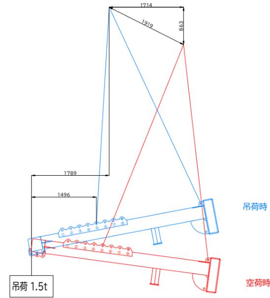
BBバランサー4700 2.0t吊り概算変動図
