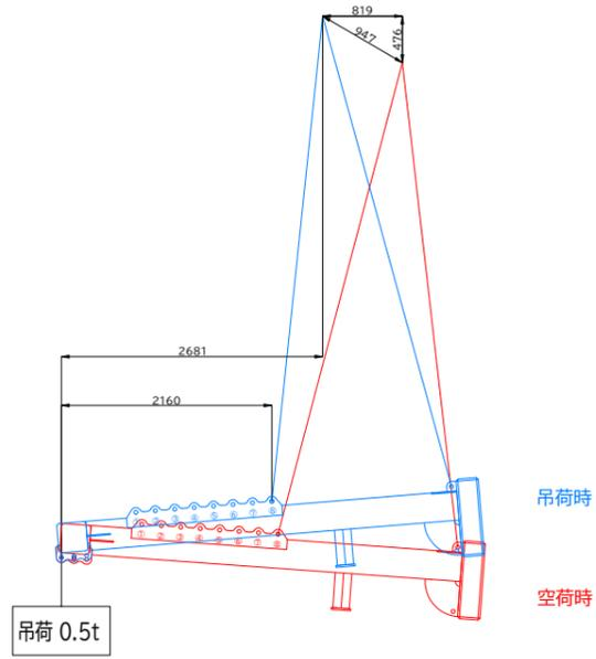
BBバランサー4700 1.0t吊り概算変動図
