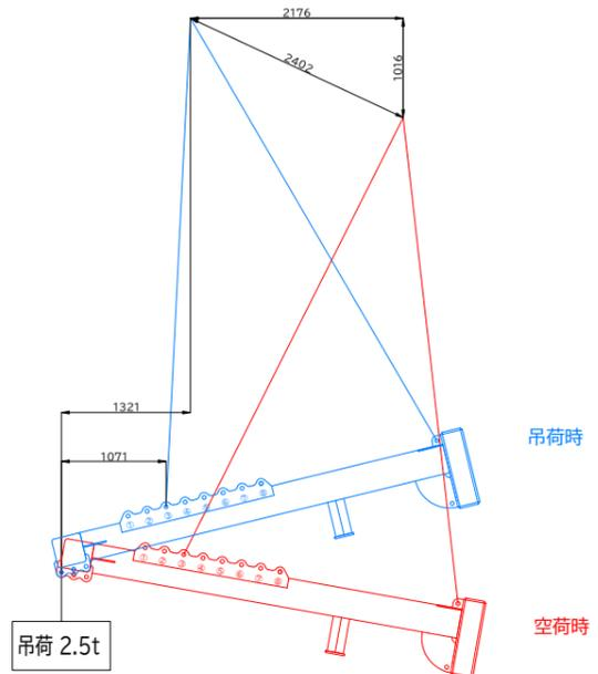
BBバランサー4700 3.0t吊り概算変動図
