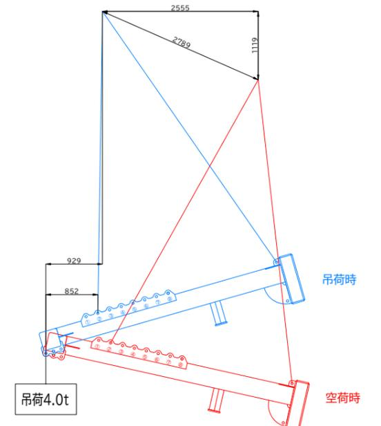
BBバランサー4700 4.5t吊り概算変動図
