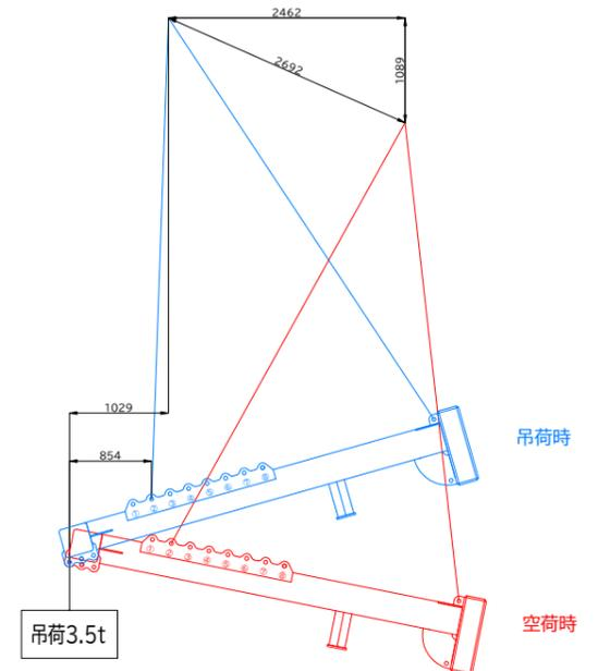
BBバランサー4700 4.0t吊り概算変動図
