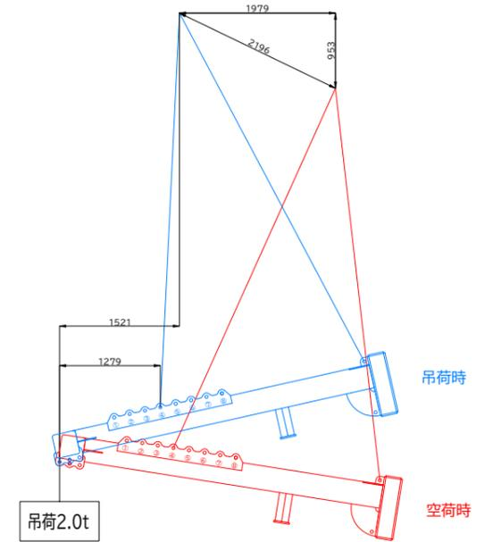
BBバランサー4700 2.5t吊り概算変動図
