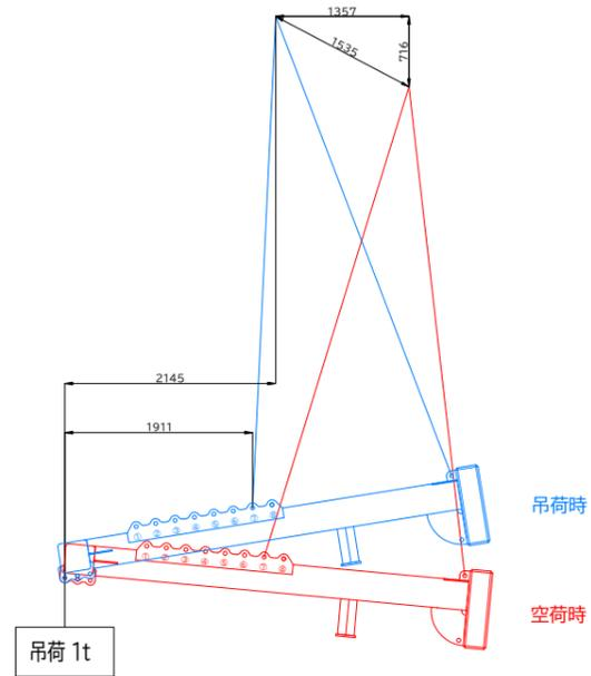
BBバランサー4700 1.5t吊り概算変動図
