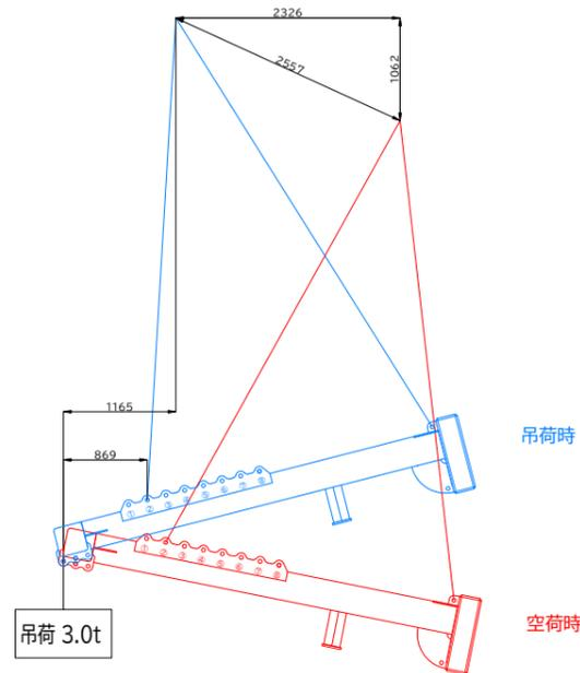
BBバランサー4700 3.5t吊り概算変動図
