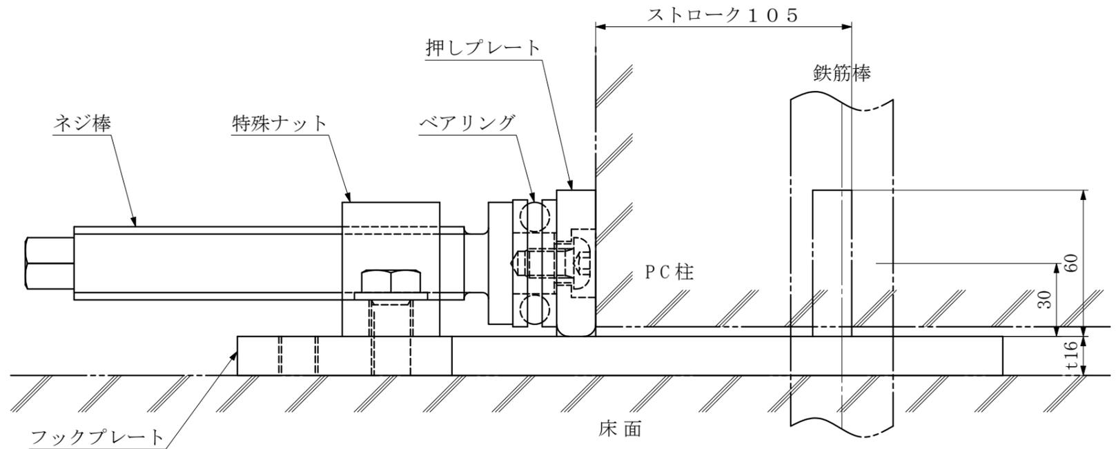
■製品名 ピタカイバータ(ベースプレート/鉄骨柱調整治具)
