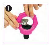
キーをボルト上部に差し 込み、リングとボルトを 固定します。
