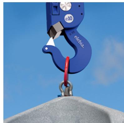
特許取得済のエレビアオート開閉フックには磁石が装備されており、フックが近づいた時、吊り具を引き寄せ、正しい位置へ調整します。その後、コントロールボタンを押してフックを閉じ、あとは吊り上げるだけです。他の特別な操作は必要ありません。エレビアはワイヤ、チェーンスリング、マスターリンク、繊維スリング、フレコンバックなど様々な吊り具に対応します。新特許技術のエレビアを用いる事により、遠隔操作で吊り荷の搬入出作業を行う事が出来ます。エレビアフックシステムはあなたへ高い安全性と生産性をもたらしてくれます。
