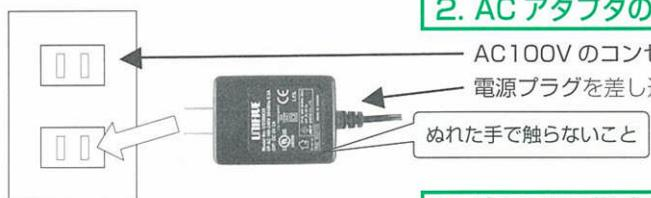
**2. AC アダプタの電源プラグをコンセントに挿す。**
