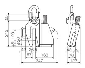
※クランプをセットする吊りピース等の寸法は、 穴径はピン径+2mm以上、板厚は開口部の -1mm以下でお考えください。 ご不明な点がございましたら何なりとお問い 合わせください。
