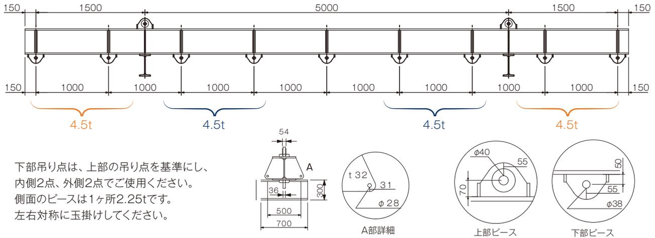
下部吊り点は、上部の吊り点を基準にし、内側2点、外側2点でご使用ください。側面のピースは1ヶ所2.25tです。左右対称に玉掛けしてください。
