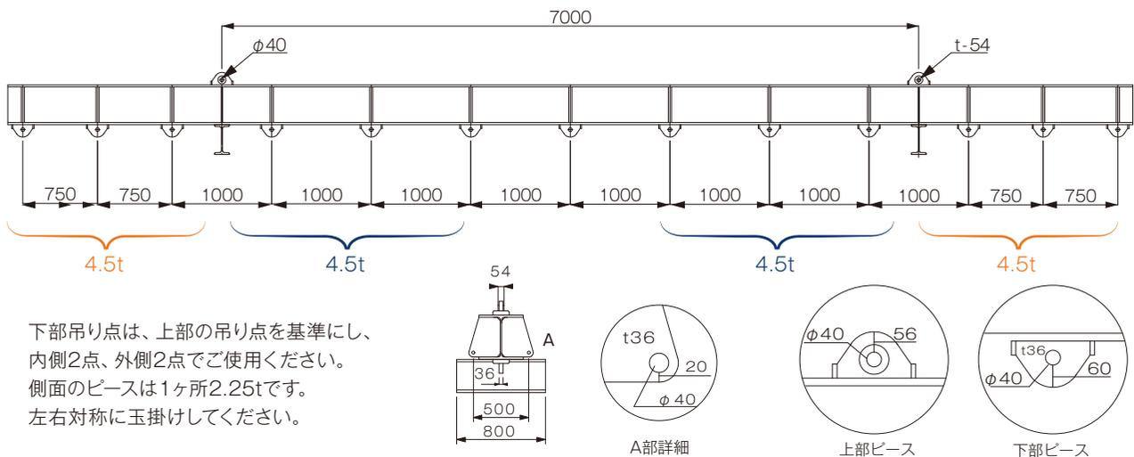
下部吊り点は、上部の吊り点を基準にし、内側2点、外側2点でご使用ください。側面のピースは1ヶ所2.25tです。左右対称に玉掛けしてください。
