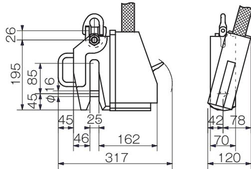
※クランプをセットする吊りピース等の寸法は、穴径はピン径+2mm以上、板厚は開口部の-1mm以下でお考えください。ご不明な点がございましたら何なりとお問い合わせください。
