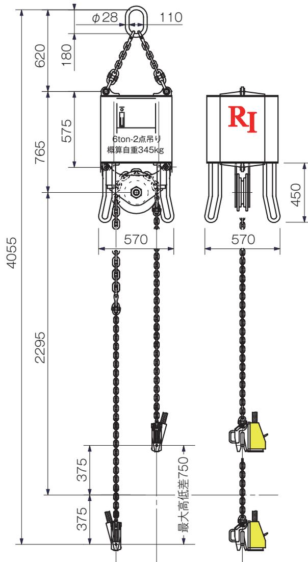
■ クランプ概算寸法図 製品質量: 14kg
